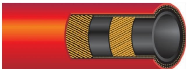
**Aplicação:** Indicada para passagem de ar, óleo, água, querosene, alguns produtos químicos e serviços pesados da indústria em geral, com tubo e cobertura resistente a óleo. Não condutiva (resistência elétrica de 1 megaohm por polegada até 1.000VDC).
